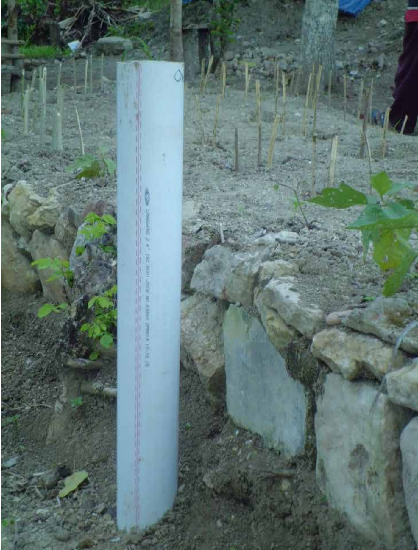
Penangkap air hujan lokal sebagai alat ukur yang disiapkan BSK dan diukur oleh masyarakat.
